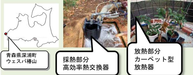
図-1 温泉廃熱利用システムの概要
