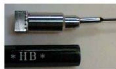
鉛筆サイズの超小型分光偏光計測センシングヘッド
