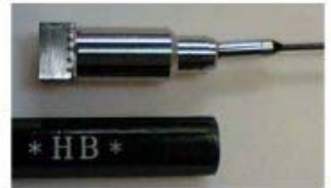
鉛筆サイズの超小型分光偏光計測センシングヘッド
