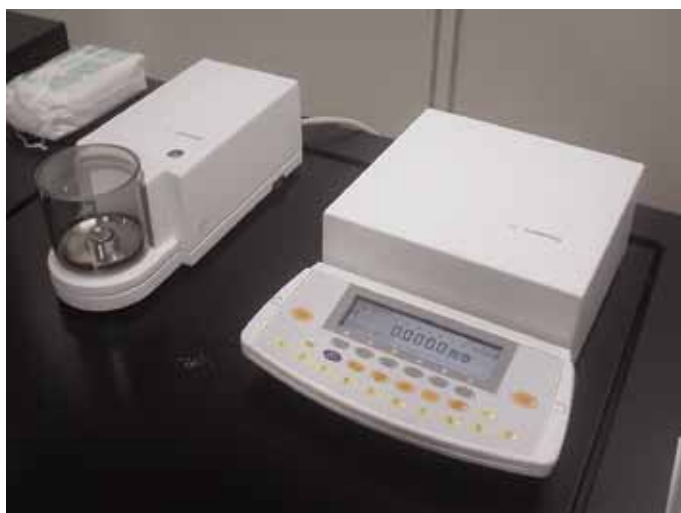
図3. 外からの振動が電子天秤に伝わらないように除振機能をもった天秤台にセットされたザルトリウス社製のウルトラマイクロ電子天秤
