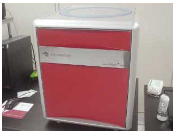
図1. 新たに導入された元素分析装置 (本体上部に120検体までセット可能なオートサンプラが装備されている)
