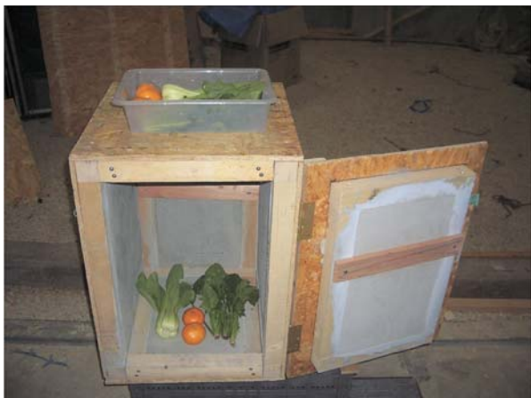
写真1 内装にホワイトブロックを用いた作物保管庫
