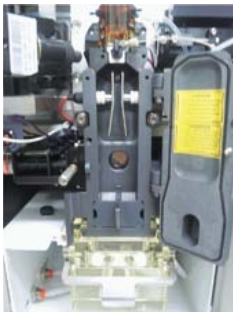
図3. ソーティング時に用いられる偏光板とチューブホルダー
