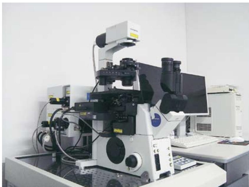
図1. 共焦点レーザースキャン顕微鏡システム
