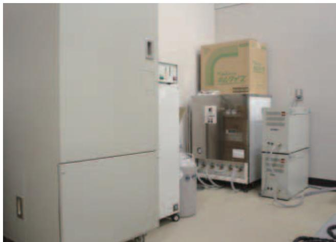
図2. 本装置後方に設置された液体窒素自動供給装置
