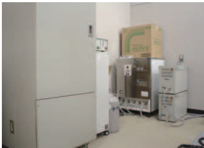
図2. 本装置後方に設置された液体窒素自動供給装置
