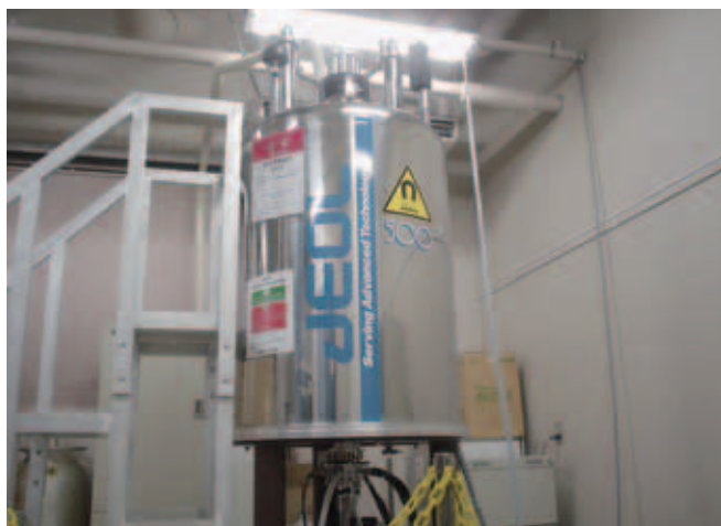
図1. 導入されたNMR装置の磁場強度11.74Tの超伝導マグネット部（マグネット上部に8本の試料までセット可能なオートサンプルチェンジャーを装備している）
